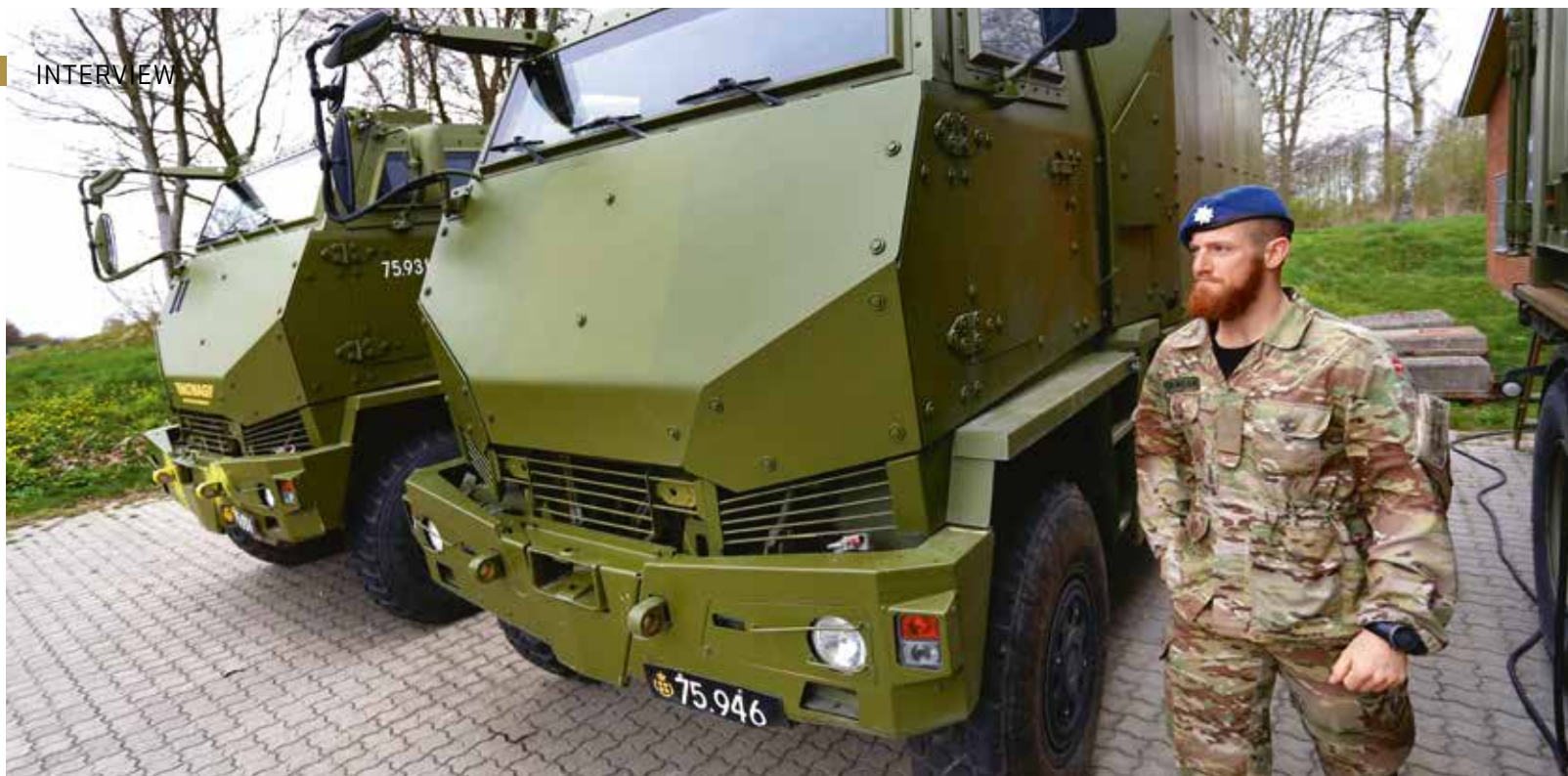
Oversergent og sektionsfører Svend på garagepladsen på Ryes Kaserne ved en af de ombyggede Duro-ambulancer, som nu anvendes til CIS-køretøj (Communication and Information System).
